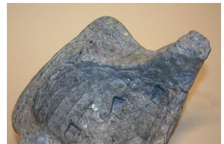
Abb. 20. Die Innenseite der Stützform. Die Silikonzapfen sind deutlich sichtbar.
