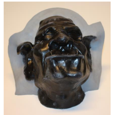
Abb. 3. Der Plastilinrand an der Stelle, wo später die Trennlinie der Form entsteht.
