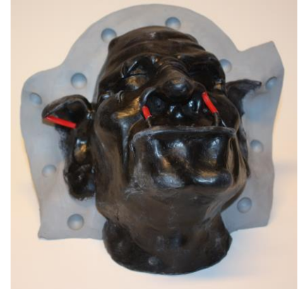
Abb. 5. Beide Schneidezähne werden mit Entlüftungskanälen versehen. Aus der rechten Ohrspitze kommt ein Kanal, der nicht nur der Entlüftung dient, sondern auch Stabilität beim Entformen bietet.
