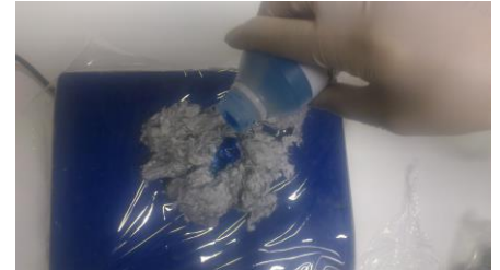
Abb. 11. 100 Gramm A-Komponente (Faser) mit 20 Gramm B-Komponente (Flüssigkeit).
