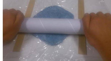
Abb. 14. Mit einer Rolle wird das Epoxy auf eine flache 3 mm dicke Scheibe ausgerollt
