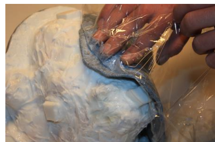
Abb. 17. Die erste Scheibe Epoxy wird über das Silikon gelegt und angedrückt.
