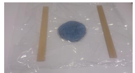
Abb. 13. Die gut durchgeknetete Masse zwischen zwei Schichten Folie. Links und rechts jeweils eine 3 mm dicke Leiste.
