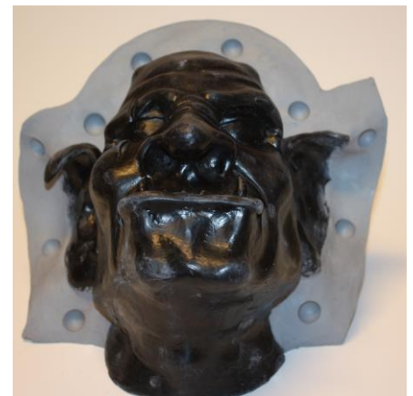
Abb. 4. Der Plastilinrand ist mit Zapfenlöchern versehen.
