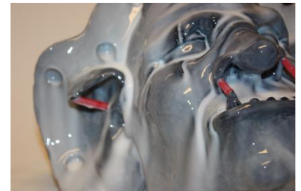
Abb. 6. Das vollständige Modell (mit Plastilinrand) wurde mit einer sehr dünnen ersten Silikonschicht versehen.
