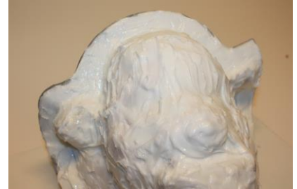
Abb. 8. Das vollständige Modell ist mit einer ca. 4 mm dicken Silikonschicht überzogen. Tiefe Öffnungen wurden gänzlich gefüllt.
