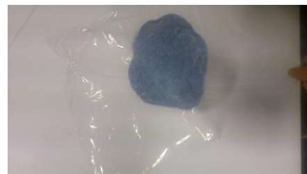
Fig. 16. Das Epoxy wird mit der unteren Folie angehoben.
