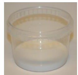
Abb. 7. Ein Silikonrest wird in einen Becher gegossen, um später Zapfen daraus zu schneiden.
