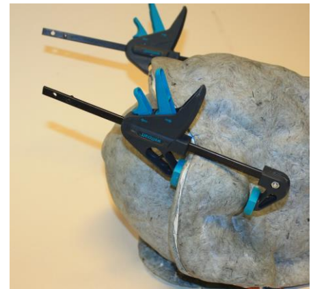
Abb. 21. Am Rand, wo zuvor das Plastilin war, werden vor dem Guss Leimklebungen angebracht.
