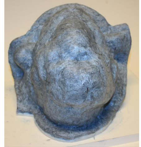
Abb. 19. Das gesamte Modell ist mit einer 3-4 mm dicken Schicht Epoxy bedeckt.
