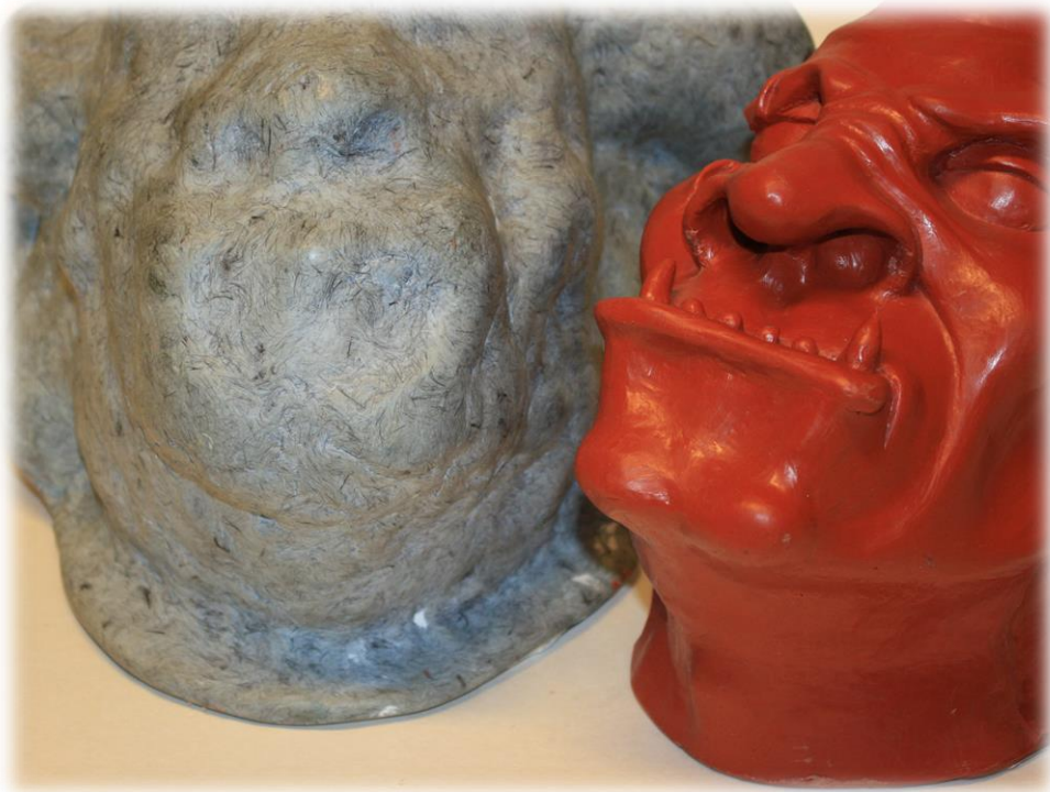
Abb. 22. Die Form, daneben eine Kopie, gegossen aus Rotations-PU.
